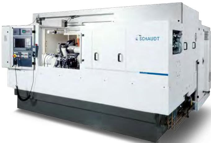
Modulare Einschleifmaschine, die mit einer schwenkbaren zweiten Spindel versehen werden kann | In der höchsten Ausbaustufe mit B-Achse und bis zu 3 Schleifspindeln
