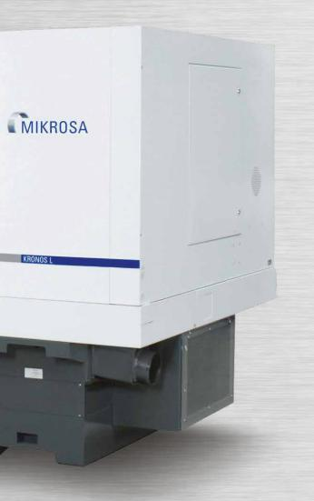
Die spitzenlose Außenrundschleifmaschine KRONOS L ist für das Einstechund Durchgangsschleifen im Durchmesserbereich von 5 bis 250 mm und mit einer maximalen Einstechbreite bis 655 mm ausgelegt. Die Basis der Maschine bildet ein Bett aus Granitan<sup>®</sup>, das der KRONOS L ein optimales Dämpfungsverhalten und ausgezeichnete Thermostabilität garantiert.
