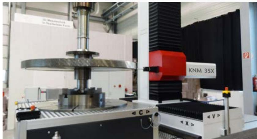
Motorische Positionierung der Messeinheit (V-Achse) auf den aktuellen Werkstückdurchmesser
