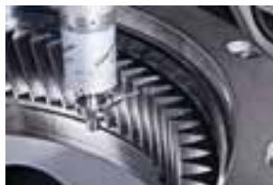
Messen einer Verzahnung in der Maschine
