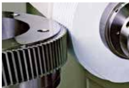
Wälzschleifen eines Stirnrades
