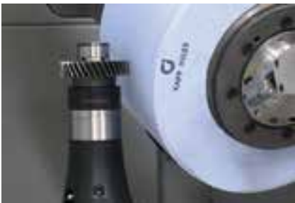
Wälzschleifen auf KN e 3G
