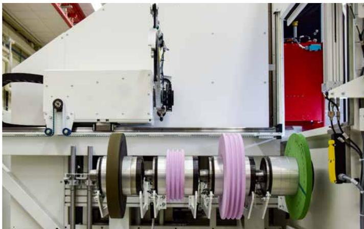
**Hohe Produktivität** dank der Möglichkeit, beispielsweise Schrupp- und Schlichtscheiben oder konventionelle und CBN-Scheiben im Wechsler vorzubereiten und damit sowohl eine hohe Abtragleistung als auch die präzise Feinbearbeitung der Oberflächen in einem Ablauf zu ermöglichen.
