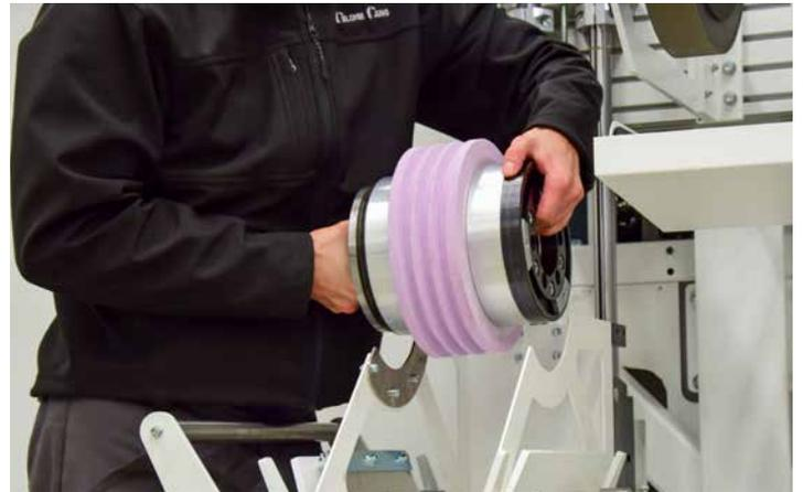
Die Beladehilfe ermöglicht ein **einfaches und sicheres Rüsten** von Schleifscheiben während des Produktionsbetriebs. Hierdurch verringern sich die Rüstzeiten zusätzlich.
