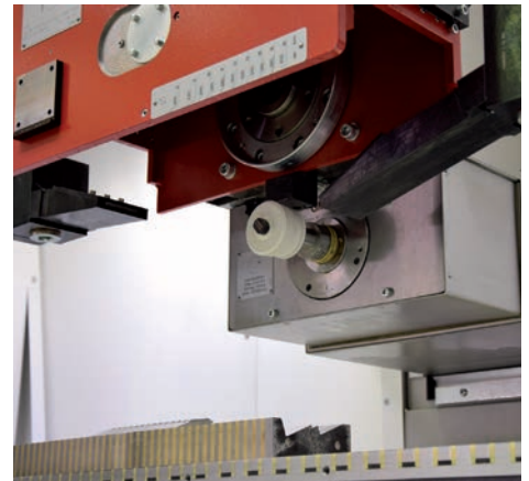
Zusätzliche Horizontalschleifspindel , 18.000 \text{min}^{-1} ; 13 kW
