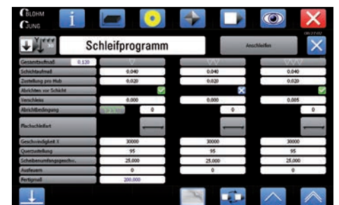
3-Schicht-Automatikzyklus: Schruppen, Schlichten, Feinschlichten mit integrierten Abrichtzyklen. Nur wenige Parameter beschreiben den kompletten Zyklus.
