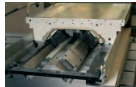
Linearmotoren und Hydrostatik: hochdynamische Achsantriebe und hochqualitative Studer Führungsbahnsysteme
