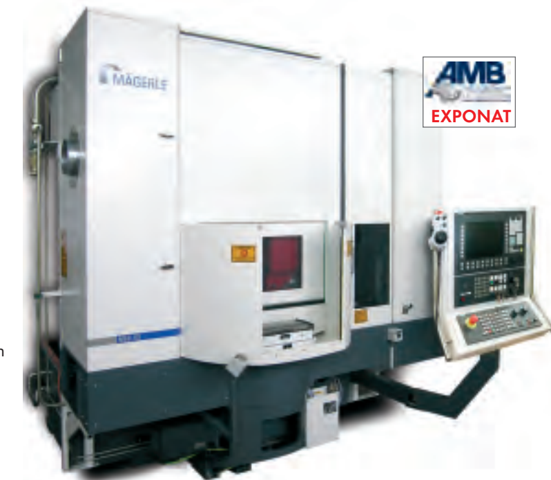
Basiert auf der äußerst erfolgreichen modularen Baureihe MGC: MGC-080.22.45, die kleinste Ausgabe der Mägerle Schleifzentren, hier mit Siemens 840D Steuerung
