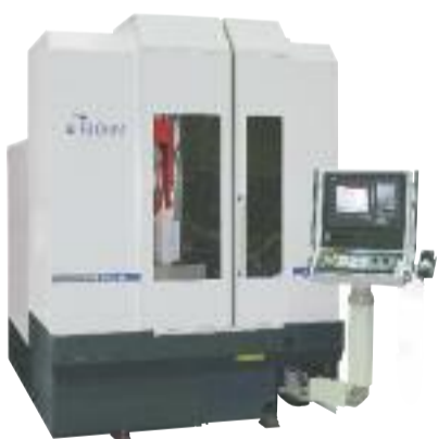
Produktionsmaschine Profimat MC 610 mit tischmontiertem Abrichtgerät. Werkstück: Curvic Coupling
