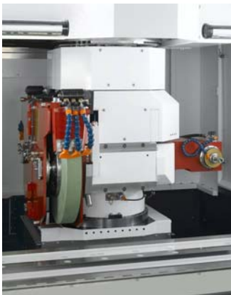
((Bild 3 / Ansicht des Revolverschleifspindelstocks))
